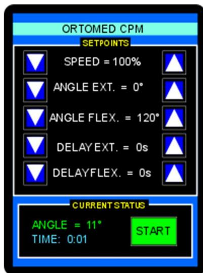
Ajustar parâmetros de Velocidade nas setas do campo – “*SPEED*”. A velocidade selecionada deverá estar em passos de 10% da máxima velocidade do equipamento.
