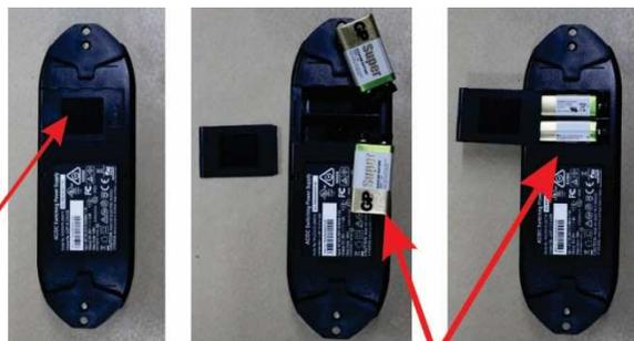
Retire a tampa da caixa de bateria. Instale ou troca as baterias.
