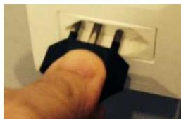
3 Apoie o aparelho com uma das mãos, e com a outra mão conecte/desconecte o cabo de força do Sonomed, como indicado na figura ao lado.
