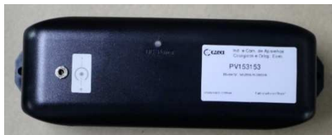
Fonte alimentação motor Megamat
